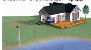
Начальная цена системы может быть немного выше, чем газового котла или центральной системы кондиционирования, это не мешает домовладельцу **ЭКОНОМИТЬ** деньги ежемесячно в процессе эксплуатации этой системы. Низкое энергопотребление достигается за счет высокого коэффициента COP системы и позволяет получить на 1 кВт затраченной энергии 3-4 кВт тепловой энергии или 2.5-3.5 кВт мощности по охлаждению на выходе.
