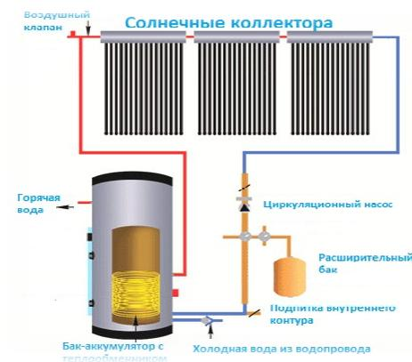
Система обладает малой инертностью, быстрым выходом на рабочий режим и позволяет обеспечить:
