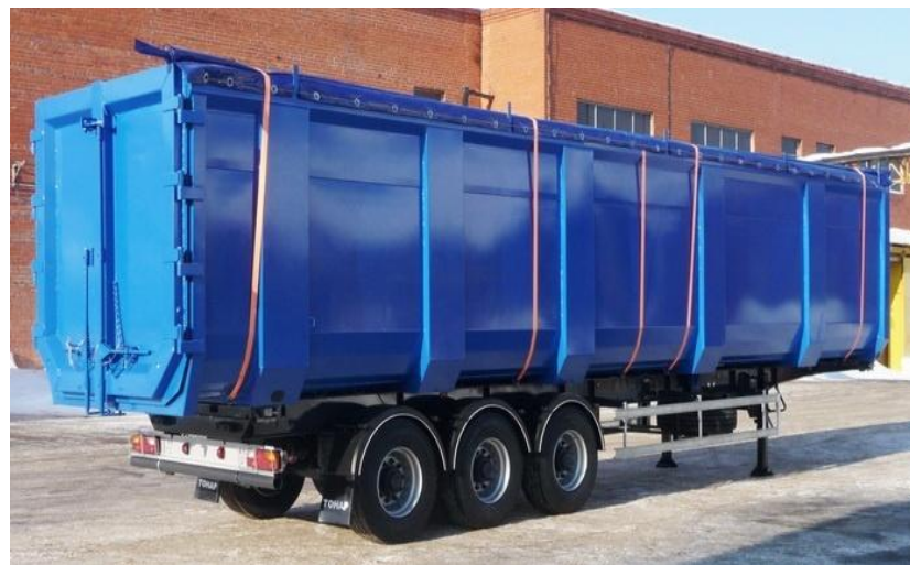
Полуприцеп «Тонар» объемом 75 куб. м. и грузоподъемностью 30 тн.
